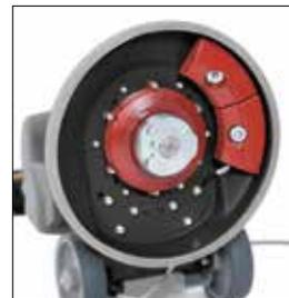
È possibile prevedere l'aggiunta di un peso supplementare per avere una maggiore capacità lavante e ottenere alte performance di lavaggio e di lucidatura.
