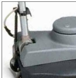
Sistema di bilanciamento eccezionale che rende l'utilizzo di questa macchina estremamente piacevole senza nessun affaticamento dell'operatore grazie alla presenza della molla a gas sul manico.
