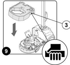
8. Inserire il serbatoio soluzione nell'apparecchio, avendo cura di non danneggiare il tubo aspirazione aria in entrata (6) del motore aspirazione ed il tubo aspirazione corpo tergipavimento (7). Per posizionare il serbatoio aiutarsi con le maniglie (3) presenti sul serbatoio soluzione (Fig.9 e Fig.10).
