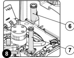
12. Adagiare il serbatoio di recupero sopra il serbatoio soluzione, avendo cura di non danneggiare il tubo aspirazione aria in entrata (6) del motore aspirazione ed il tubo aspirazione corpo tergipavimento (7). Per posizionare il serbatoio aiutarsi con le maniglie (3) presenti sul serbatoio soluzione (Fig.9 e Fig.10).
