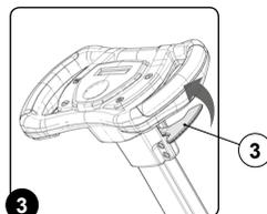
5. Ruotare il piantone di comando in posizione verticale (Fig.4).
