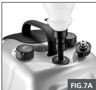
1. A macchina fredda e non in pressione, riempire la caldaia attraverso l'imboccatura del tappo di sicurezza (FIG. 7a), quindi chiudere avvitando e premendo verso il basso il tappo
